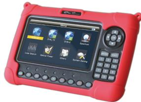
Strumento professionale per il corretto posizionamento dell'antenna (DVB-T e DVB-T2), della parabola (DVB-S e DVB-S2 anche per SCR Unicable) con Analizzatore di Spettro in tempo reale, DVB-C (fibra ottica). Adatto anche per il controllo telecamere tramite ingresso video-composito.
